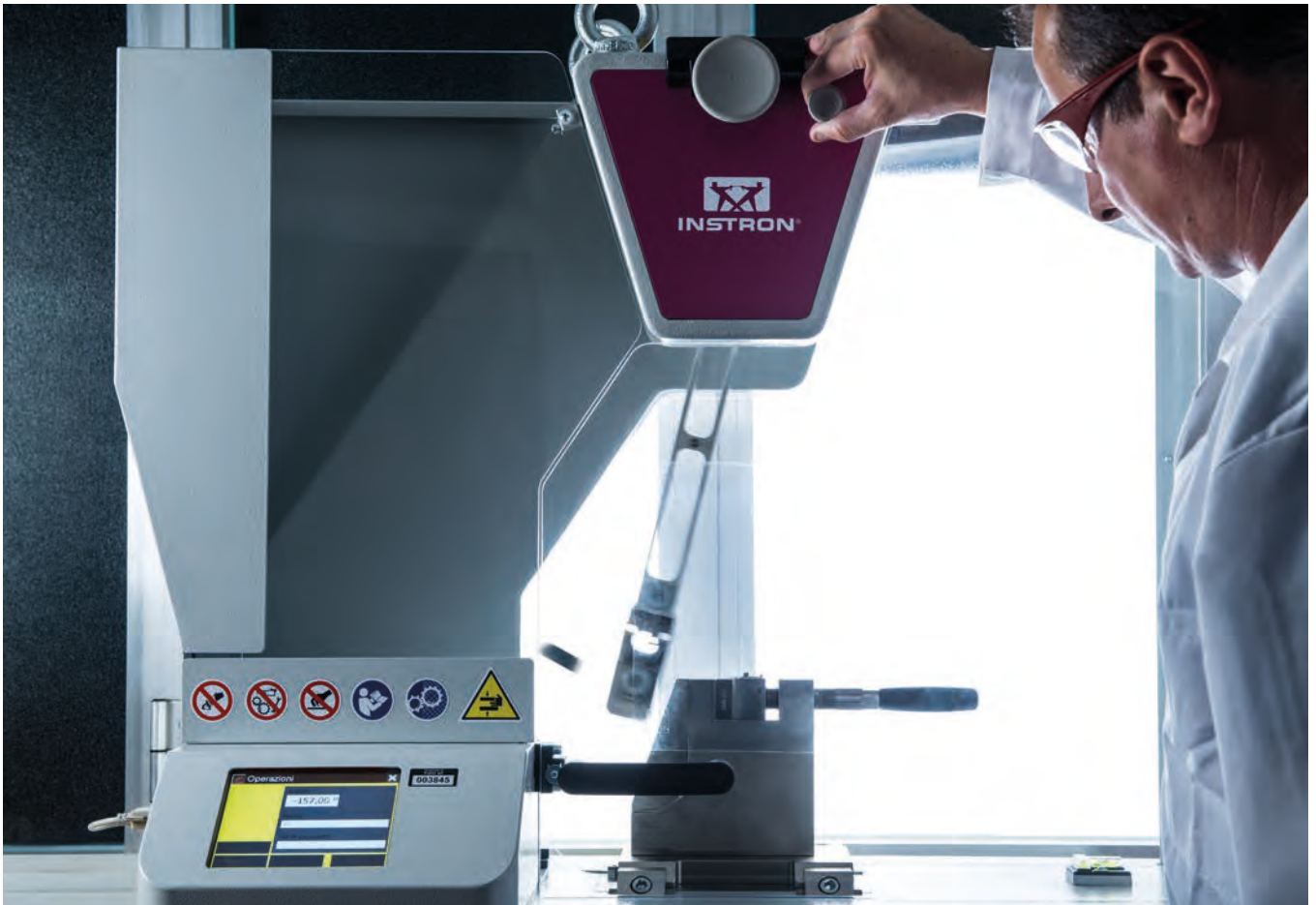
Prova d'impatto con pendolo.
