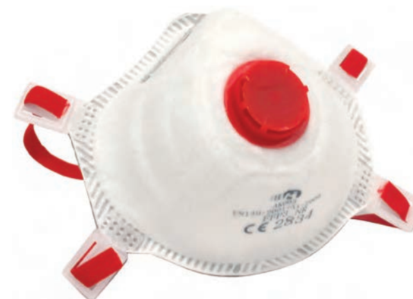
1122/6 MASCHERINA FFP3 CON VALVOLA Con valvola di espirazione in plastica Protezione da aerosol solidi e/o liquidi tossici Livello massimo di utilizzo 50xTLV
