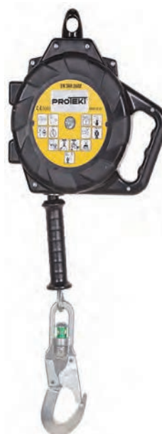
R10 DISPOSITIVO ANTICADUTA A FUNE Con riavvolgimento automatico Assorbitore di energia Omologato per utilizzo in verticale e orizzontale Fune metallica diametro 4 mm lunghezza 10 m
