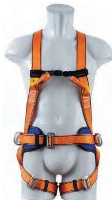
1141/40 ATTACCO DORSALE+STERNALE+CINTURA DI POSIZIONAMENTO Ancoraggio dorsale in acciaio con piastra di assorbimento Peso kg 1,12 3 fibbie di chiusura a regolazione rapida 2 attacchi sternali con asole in nastro Cintura di posizionamento con 2 attacchi laterali
