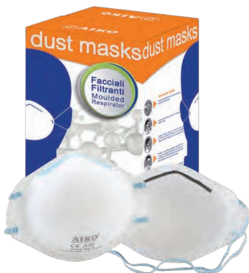
1122/31 MASCHERINA FFP1 SENZA VALVOLA Per polveri e aerosol a bassa nocività Livello massimo di utilizzo 4,5xTLV
