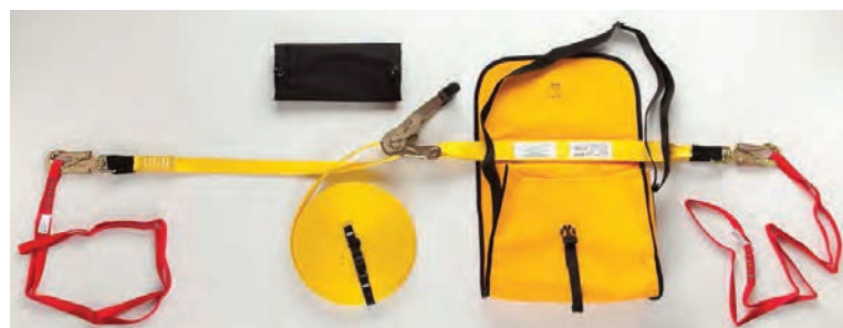
1141/49 LINEA VITA TEMPORANEA PER 3 PERSONE Nastro con tensionatore lunghezza 20 metri Fettucce di ancoraggio Moschettoni girevoli - Borsa con tracolla Distanza massima di flessione 5,4 metri
