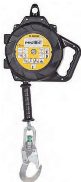
R20 DISPOSITIVO ANTICADUTA A FUNE Con riavvolgimento automatico Assorbitore di energia Omologato per utilizzo in verticale e orizzontale Fune metallica diametro 4 mm lunghezza 15 m
