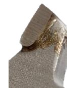
Denti in Carburo di Tungsteno
