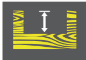
Profondità di piallatura migliorata (2,0 vs 1,6mm)
